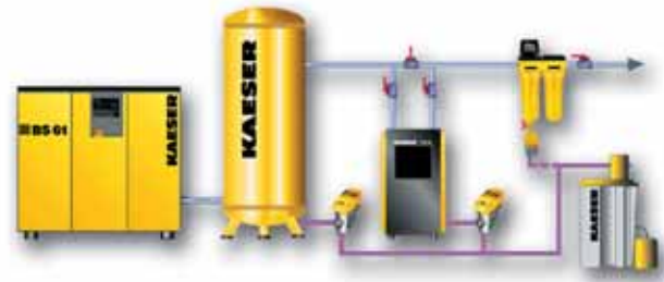
Tratamiento de aire comprimido (filtros, tratamiento de condensados, secadores de adsorción, secadores de carbón activo)
