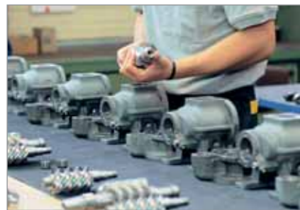
Montaje de los bloques
