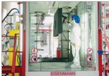
El recubrimiento con pintura sinterizada proporciona a las máquinas una protección duradera
