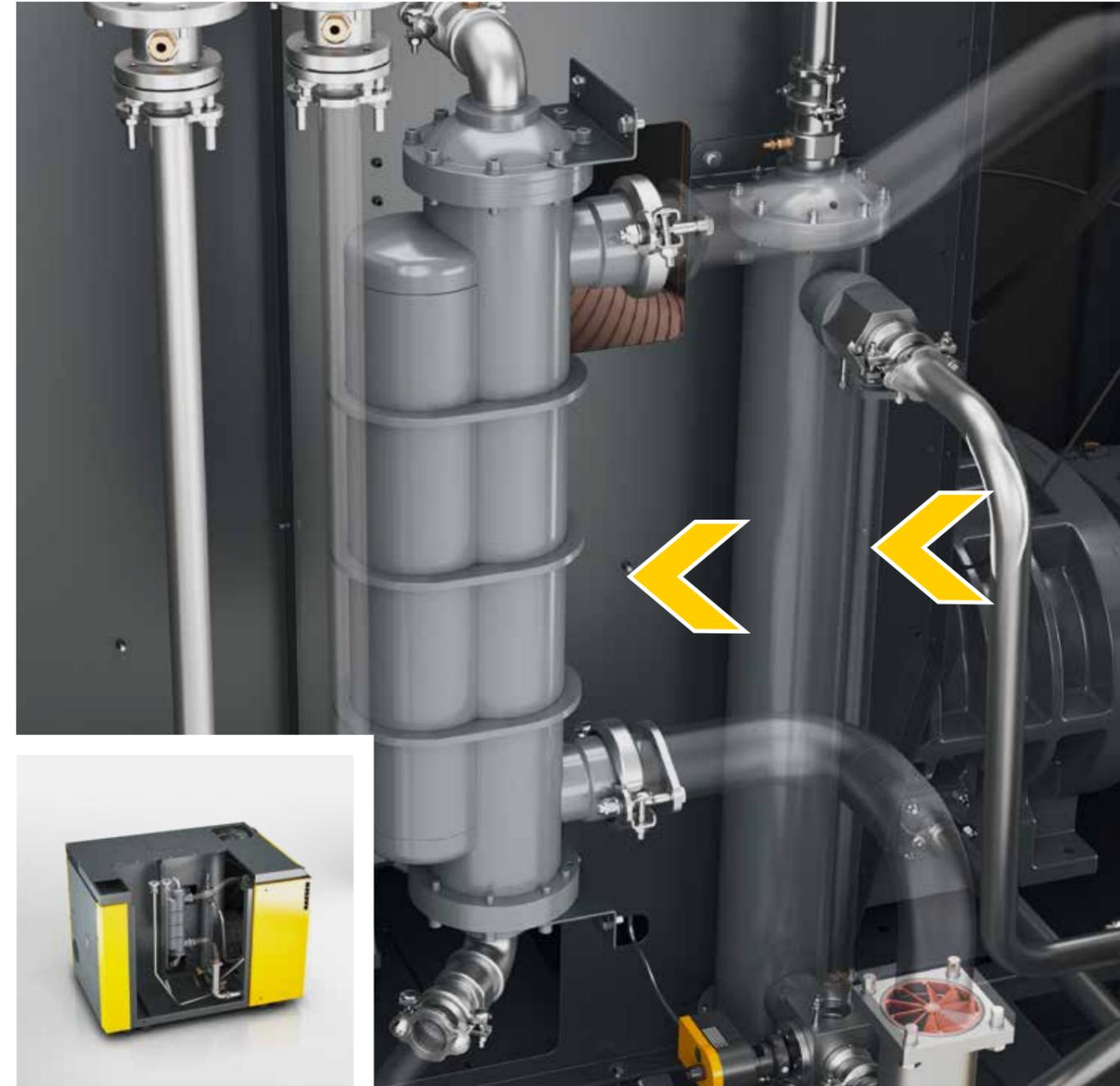
Los intercambiadores de calor tubular de aleación de cobre-níquel (CuNi10Fe) son igual de eficaces que los intercambiadores de placas, pero menos sensibles a la suciedad, más robustos y resistentes a la limpieza mecánica. Además, los componentes del enfriador son muy fáciles de cambiar.
